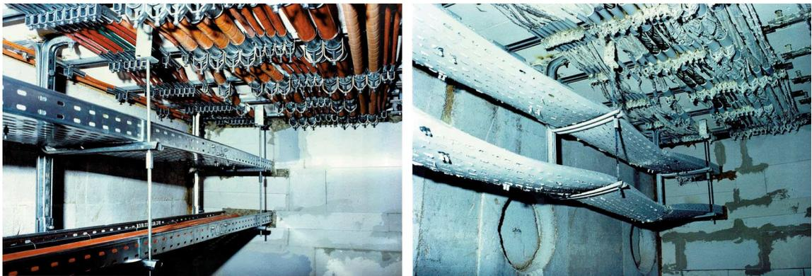
Prüfung von Kabelanlagen im Brandofen nach DIN 4102-12 mit verschiedenen Verlege-techniken: links vorher, rechts nachher (Bild: Dätwyler)
